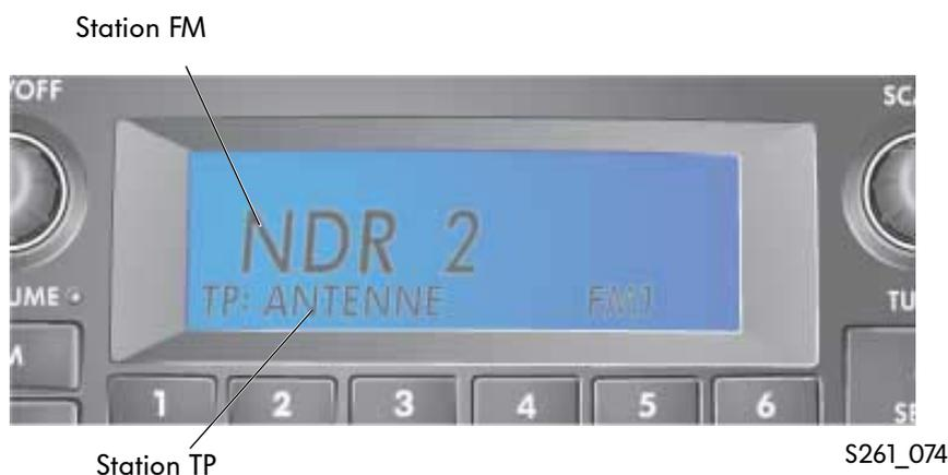
Lorsque le "récepteur TP" n'est pas utilisé pour la réception de stations de radioguidage, avec la touche TP désactivée par exemple, il assiste le "récepteur FM". Il vérifie en outre l'existence de fréquences alternatives, proposant une meilleure réception de la station FM sélectionnée.
